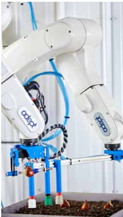
Automatisation de la plantation de bulbes pour la production en serre
